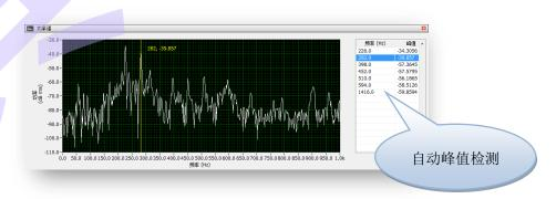
SignalPad 功率谱分析视图使用 FFT 计算并显示信号的功率谱。功率谱计算参数、显示参数由用户自定 义。可同时计算和显示多个信号的功率谱。自动检测和显示功率谱的峰值位置和值大小。功率谱线数可以 设置,线数多少没有限制,也无须是 2 的 N 次方。
