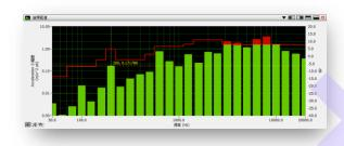
SignalPad 倍频程视图计算并显示信号 1/24、1/12、1/6、1/3 和 1 倍频谱, 倍频程分析也称等比带宽 (CPB)分析,常用在声音振动分析中。倍频程谱考虑了人体对不同频率成分的不同生理反应,比较科学地反 人体对声音振动的感受。倍频程视图支持 A、B、C、Z 记权,支持多种平均模式。
