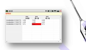
SignalPad 振动级和声压级视图分别计算振动信号和声压信号的幅度大小。可同时计算多个通道的振动 级和声压级,在表格中显示各个通道的振动级或声压级的均值、最大值和最小值。可为每个通道分别设 定限值,最大值超过限值即报警。
