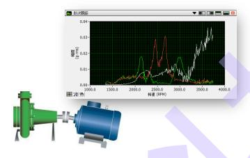
SignalPad 阶次谱视图和阶次跟踪视图主要应用在旋转机械的故障诊断和状态监测。可以直观的显示系统中各个部件引起的振动或噪声,有利于找到振动源或噪声源。阶次跟踪视图可同时跟踪多个阶次,按照时间、转速或周数跟踪。
