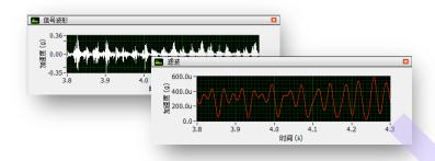
SignalPad 滤波视图去除信号中不想要的频率成分,如一般的随机噪声为高频信号,用低通滤波可以去除高频噪声,提高信号的信噪比;用带阻滤波器可以去除 50Hz 工频干扰。滤波视图支持低通、高通、带通、带阻多种滤波器类型,也可选择 Butterworth、Chebyshev 等多种滤波器设计方法。可查看视图所用滤波器的幅频响应和相频响应。
