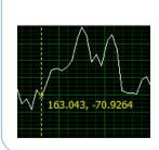
可用光标读取波形上任意点的值。光标用鼠标拖动,即时显示光标所在点的 X 和 Y 值。光标值显示标签的位置可用鼠标随意拖动。如不需要,光标可以隐藏显示。 波形图上显示多个信号波形时,光标可切换与不同信号波形邦定,光标显示邦定信号波形的值。
