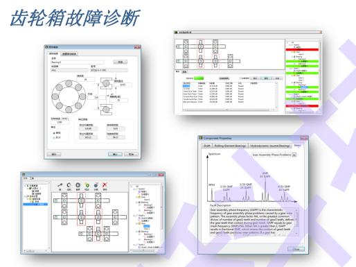
SignalPad 齿轮箱故障诊断视图主要用于对齿轮箱故障的阶次分析,支持常见的轴、齿轮、轴承故障分析。使用图形化的配置界面可以很方便地对齿轮箱的结构及机械参数进行直观的描述并分配采集所得信号。 根据用户所描述的轴系耦合关系,*软件将自动计算出不同轴系之间的转速关系*,同时根据部件的物理尺寸 *自动计算出不同部件主要的故障特征频率*。用户可以通过预设阈值,直观地判断部件的工作状态。同时, 该视图还具有数据库功能,不仅可以用于报存部件的机械尺寸参数,还可以帮助用户记录大量样品的测试 结果以便于形成有效的判据。
